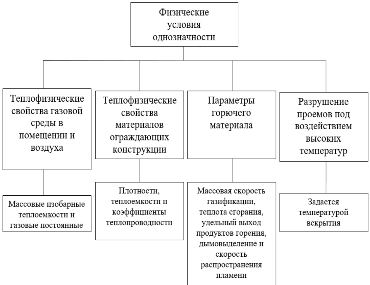
Рисунок 2.3 – Физические условия однозначности интегральной математической модели пожара
