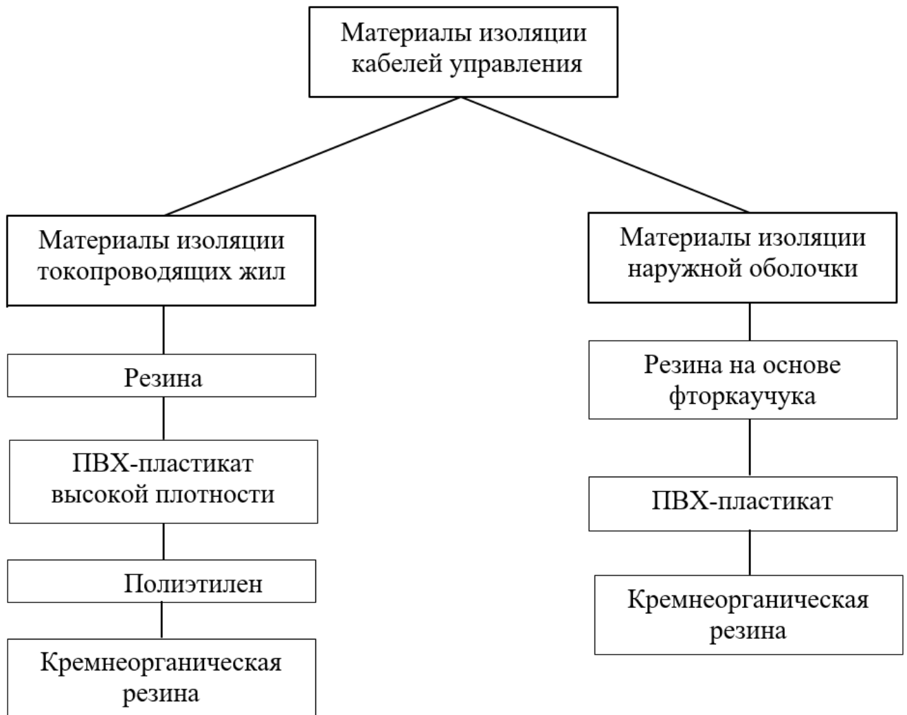
Рисунок 1.9 – Материалы изоляции токопроводящих жил и наружных оболочек кабелей управления, применяемых на объектах энергетики
